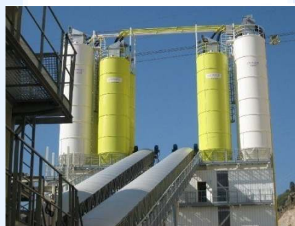
Transporte neumático cemento y ceniza para varios destinos. Suministro continuo a planta.
