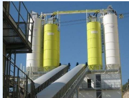
Transporte neumático cemento y ceniza para varios destinos. Suministro continuo a planta.
