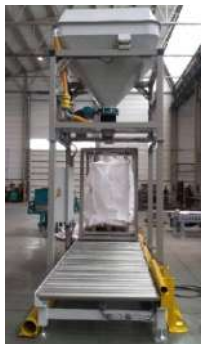
Sistema llenado big bag automático con camino de rodillos, carrusel.
