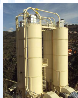
Transporte neumático cemento y ceniza para varios destinos. Suministro continuo a planta.
