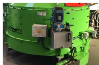
Hidráulico para accionamiento de la compuerta.
